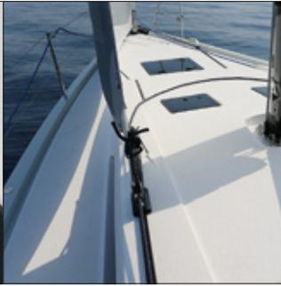
**Optimal.** Weit innen am Kajüt-dach liegende Genuaschiene
