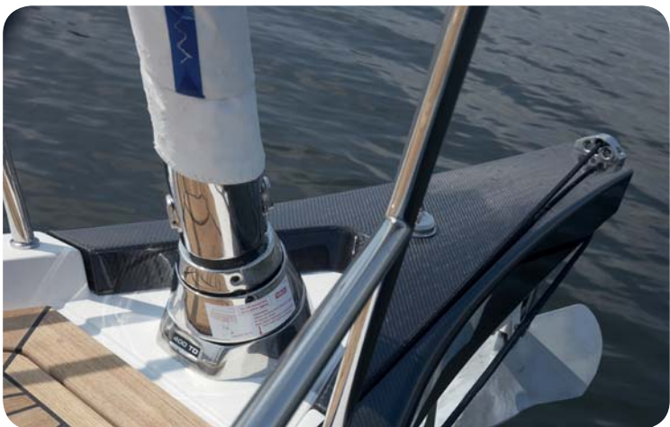
Rulleforstaget er placeret under dækket. X4 9 fås med forskellige bovspryd med ankerrulle. Her i kulfiber.
