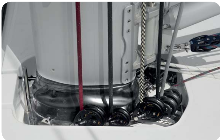
Alle fald og hal fra masten er ført direkte under ruffet ved masteroden.
