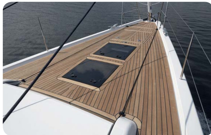
Forlugerne er flush-monteret. Forrest ses et stuverum, hvorfra man f.eks. kan hale en gennaker direkte op.
