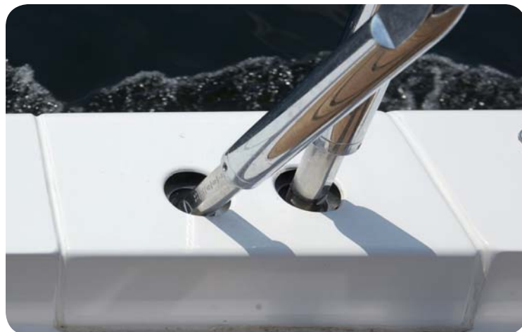
Vangskruerne er placeret helt i borde, og er ført ned til de skjulte røstjern gennem båden brede lønning.
