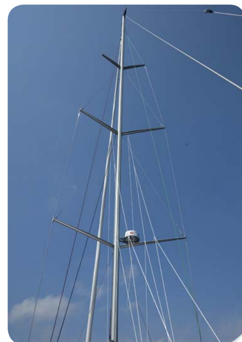
Den brede 9/10s rig er med tre salinger og rodrig. Den kan spændes hårdt, fordi båden er bygget stift med epoxy.
