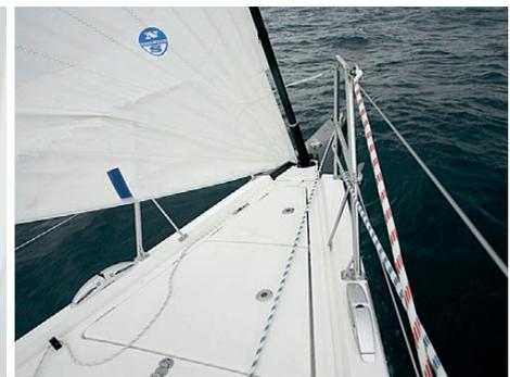
**Versenkt.** Rollrefftrommel unter Deck, damit das Unterliek schön mit dem Deck abschließt
