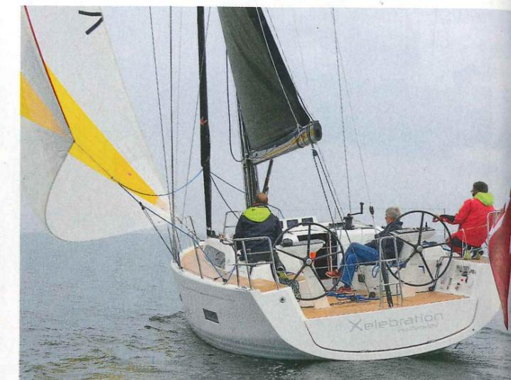
**Bouchain discret.** Les sections arrière de la carène sont marquées par un bouchain bien visible à partir duquel le bordé est plutôt évasé.
