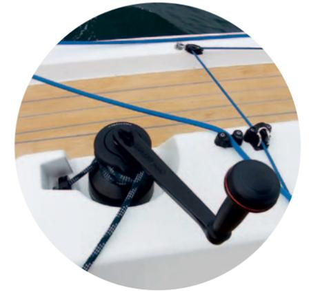
Un dettaglio del winch della randa (qui quello di sinistra) sistemato sul paramare e parzialmente incassato.
