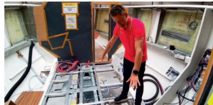
Il Ceo del cantiere X-Yachts all'interno di una barca in costruzione ci spiega la forza della gabbia in acciaio galvanizzato. I serbatoi di acqua e carburante sono centrali.
