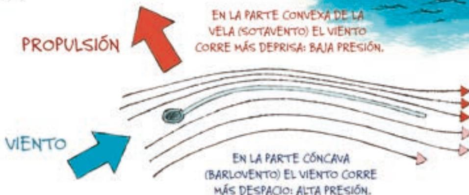
4 - ESTA DIFERENCIA DE VELOCIDAD ENTRE LAS DOS CARAS DE UNA VELA ES LA MISMA QUE TIENEN LAS PARTES SUPERIOR E INFERIOR DE LAS ALAS DE UN AVIÓN. EL AVIÓN VUELA PORQUE LAS ALAS PASAN DE UNA PRESIÓN ALTA A UNA BAJA. AL TRABAJAR EN UN PLANO HORIZONTAL LA FUERZA QUE PRODUCE ESTE CAMBIO DE PRESIÓN ES ASCENDENTE.
