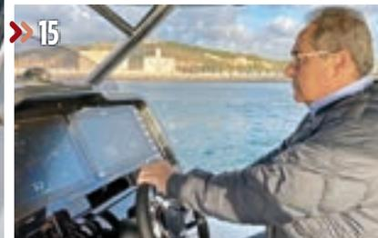
alto (en este caso presentaba alguna deformación el metacrilato) además de contar con una consola casi vertical donde cabe todo lo necesario, especialmente dos grandes pantallas multifunción. Las palancas electrónicas y el joystick quedan bastante verticales, pero ello no es obstáculo para que se pueda controlar bien el barco. Un puesto de altura, ergonómico y acorde a la elegancia del resto del barco.
