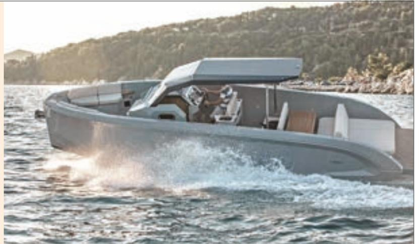
eléctrica con un abanico de potencia nominal de 105-460 kW y batería de 47 a 234 kWh.
