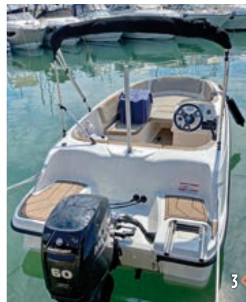
» Velocidad máxima: 28 nudos a 6.000 rpm. » Velocidad de crucero: 16,9 nudos a 4.000 rpm, con un Mercury 60 de 60 Hp. » Tiempo de planeo: 5 segundos. » Aceleración de 0 a 28 nudos: en 20 segundos. » Autonomía: en torno a las 62 millas a régimen máximo y unas 84 millas a régimen de crucero. » Precio: 29.760 euros, con un Mercury 60 ELPT EFI de 60 Hp, sin impuestos.
