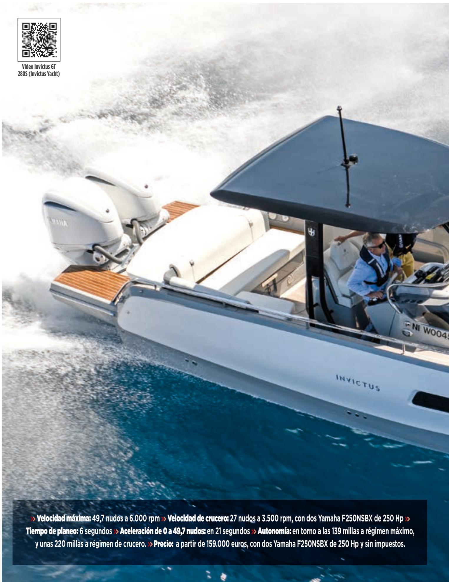
» **Velocidad máxima:** 49,7 nudos a 6.000 rpm » **Velocidad de crucero:** 27 nudos a 3.500 rpm, con dos Yamaha F250NSBX de 250 Hp »
