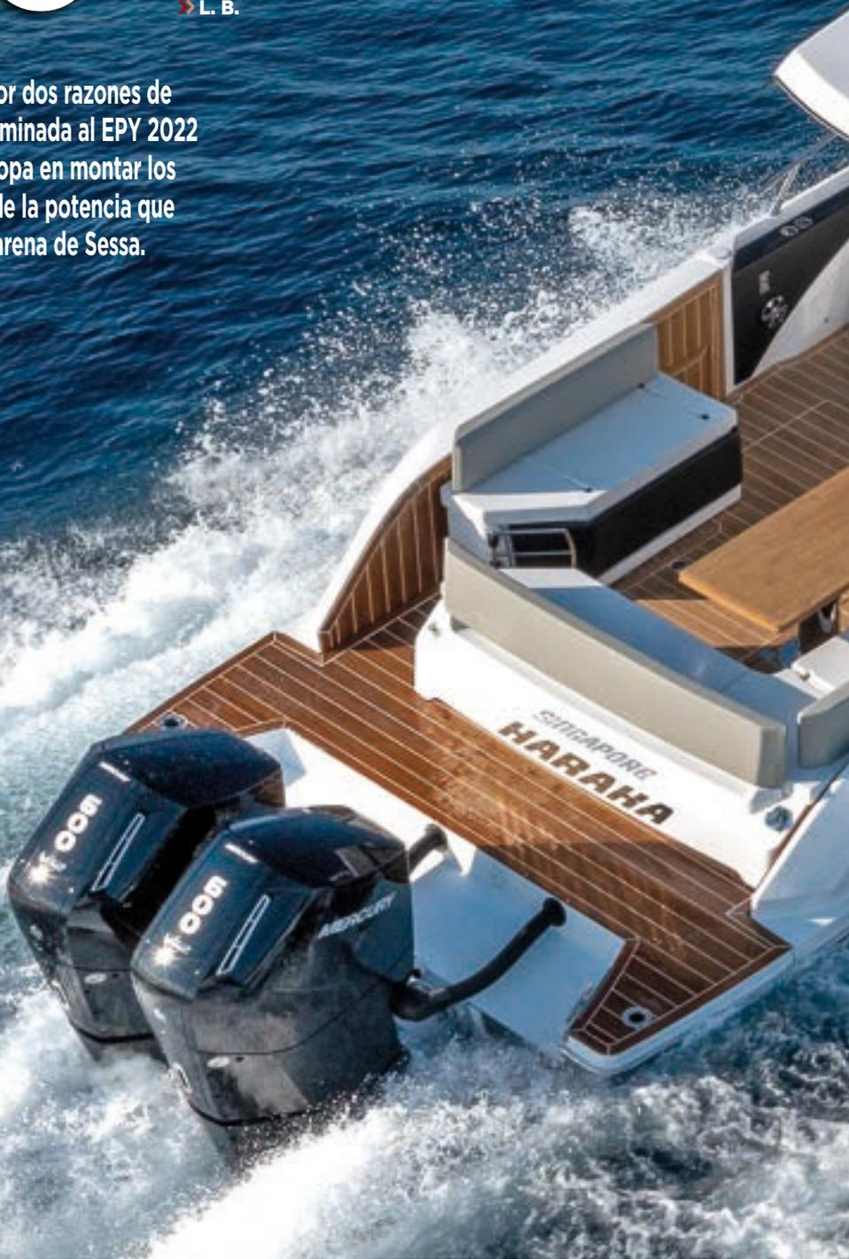
» Velocidad máxima: 52 nudos a 6.400 rpm. » Velocidad de crucero: 29 nudos a 4.000 rpm, con dos Mercury Verado 600 V12 de 600 Hp. » Tiempo de planeo: 5 segundos. » Aceleración de 0 a 52 nudos: en 15 segundos. » Autonomía: en torno a las 127 millas a régimen máximo; y unas 228 millas a régimen de crucero. » Precio: a partir de 304.000 euros, con dos Mercury Verado 600 V12 de 600 Hp, sin impuestos.
