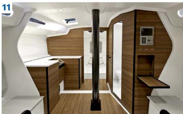
**11.** El sistema modular permite desmontar muebles y puertas para aligerar el barco en condiciones de regata y reinstalarlos para la navegación de crucero.
